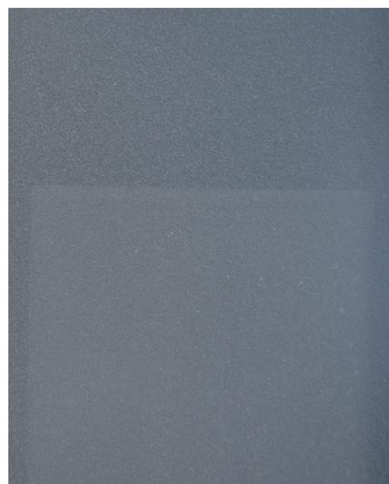
**Haute Durabilité Ral 7016, Interpon D2525 Structura, Qualicoat Classe 2**
