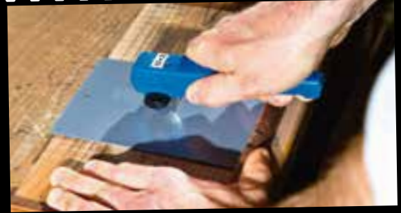
Test mécanique - contrôle de la conformité du laquage
