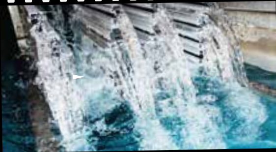
Bain de traitement des profils avant laquage
