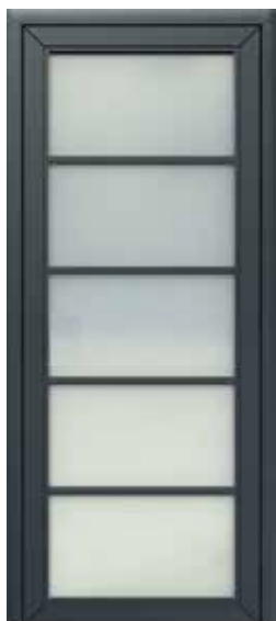
LINÉAL Porte aluminium - Vitrage feuilleté 44.2 - 1 face dépoli acide - Petits bois intégré
