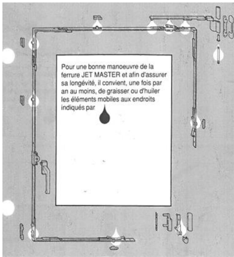
Pour une bonne manœuvre de la ferrure JET MASTER et afin d'assurer sa longévité, il convient, une fois par an au moins, de graisser ou d'huiler les éléments mobiles aux endroits indiqués par
