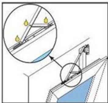
Le schéma suivant montre les points à graisser pour un compas d'oscillo-battant.
